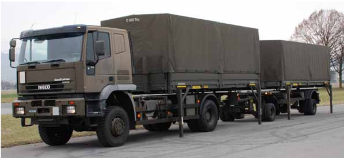
Lastwagen, 4x4, mit Wechselaufbau und Wechselaufbauanhänger
